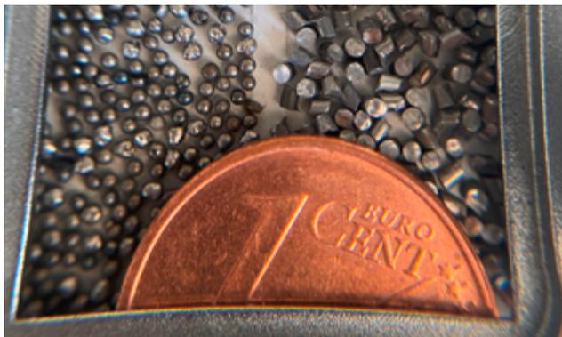
*Millionen von Kugeln aus arrondiertem Drahtkorn erzeugen beim Aufprall mit hoher Geschwindigkeit eine Eigenspannung in den Oberflächenschichten des Materials*
