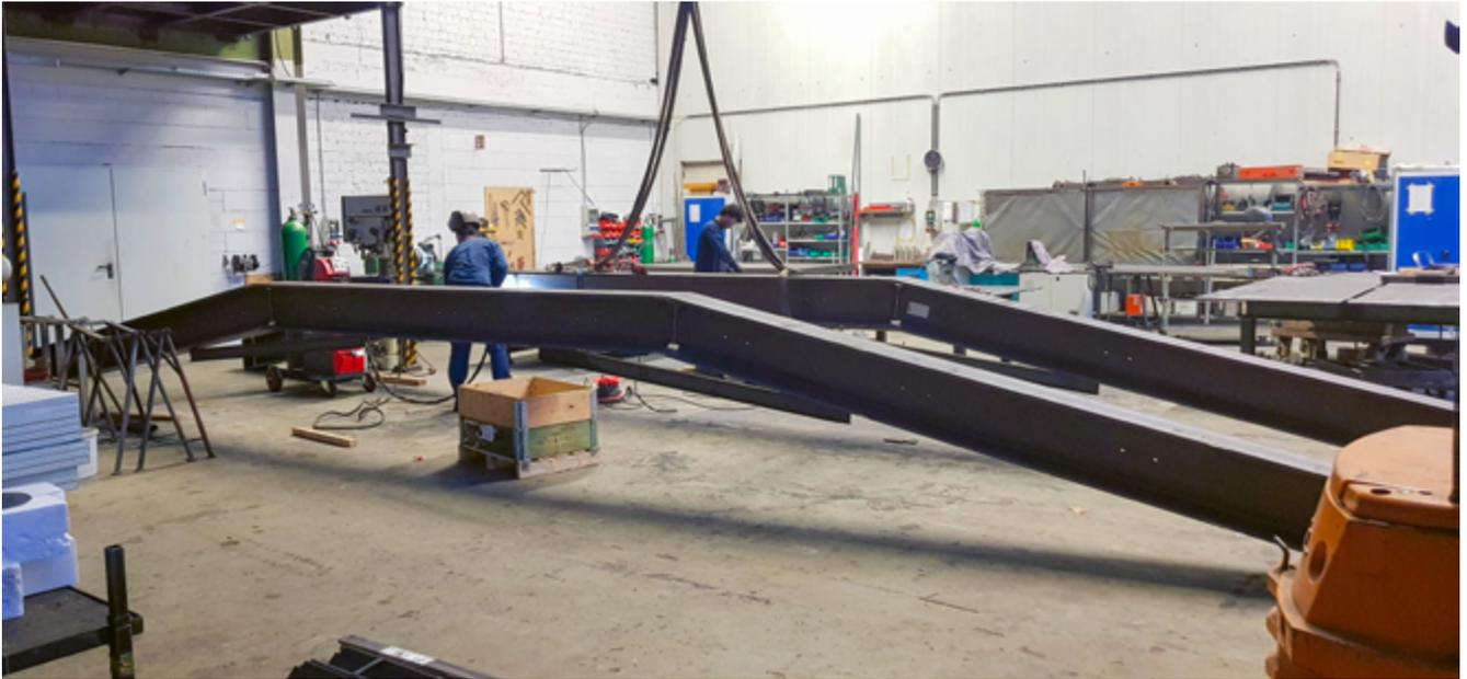
Blick in die Werkstatt bei der Fertigung der Komponenten „in einem Stück“. Foto: Thomas Hammer
