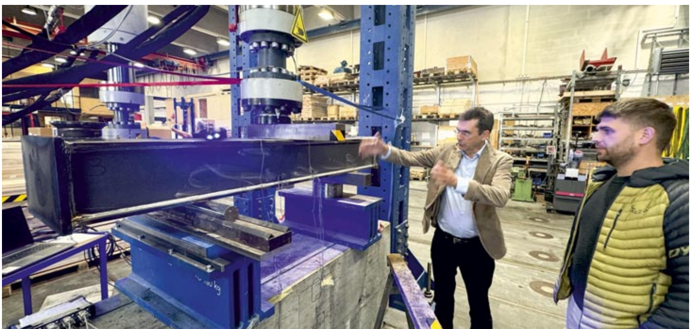
Dauerprüfung für einen Stahlträger im Labor der TU München
