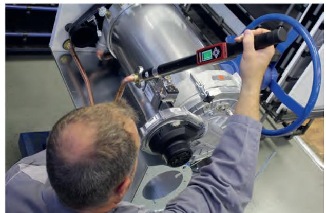
daraus die Prozessfähigkeit des jeweils verwendeten Schraubwerkzeugs abgeleitet.
