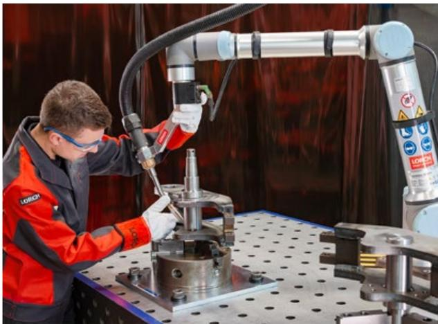
Deutlich erweitert wurde die Lorch Cobotronic Software. In zwölf Sprachen abrufbar bietet sie Zusatzfunktionen wie Intervallschweißen, Pendeln oder eine Spot-Funktion zum Heften. Noch schnelleren Zugriff auf die wichtigsten Funktionen bietet das QuickAccess Menü. Es können Parameter und Einstellungen wiederkehrender Schweißnähte als Favoriten abgespeichert werden.
